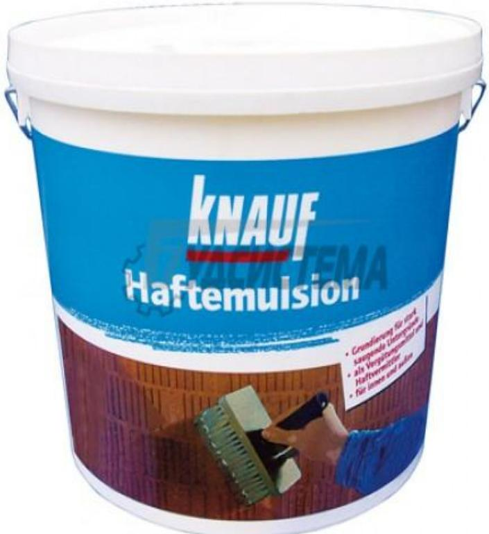
***Кнауф Haftemulsion** — это изготовленная промышленным способом, концентрированная эмульсия для улучшения сцепления. Перед использованием разбавляется водой. Используется для грунтования гладких, слабовпитывающих и невпитывающих оснований (старой плитки, террако, цементно-волокнистых плит, досок, ДСП, фанеры) перед укладкой плитки. Она также используется в качестве добавки для улучшения качества монолитных полов и строительного раствора. Грунтовка подходит для наружных и внутренних работ.*
