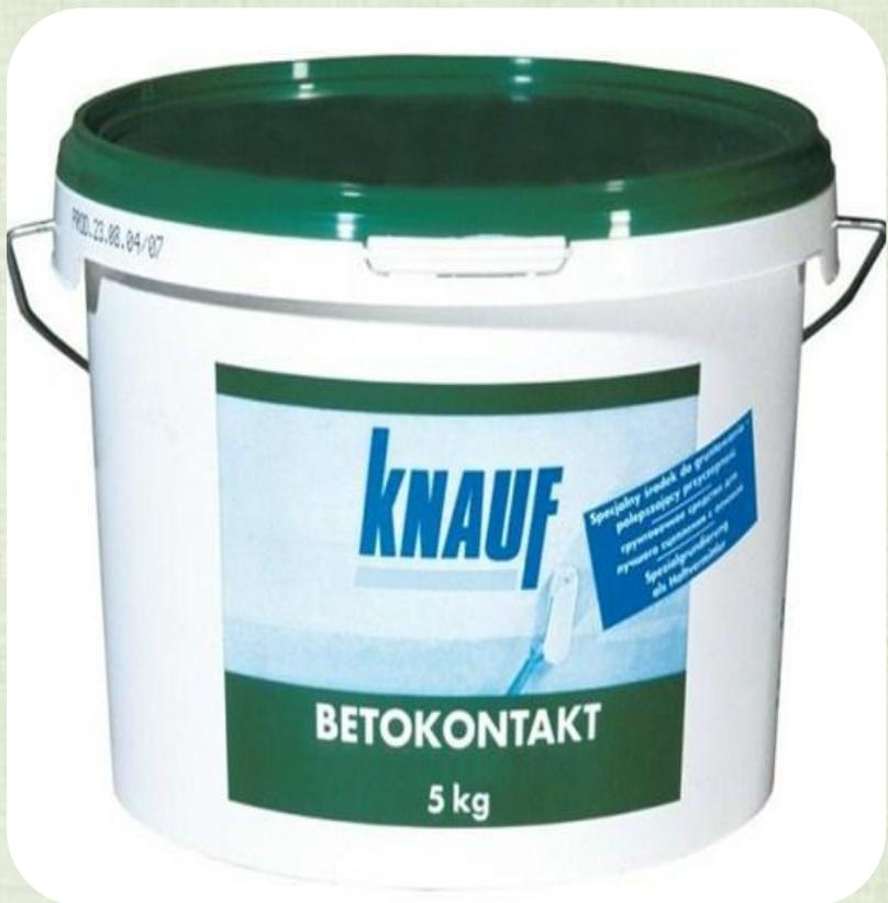
**Бетоноконтакт** - штукатурный адгезионный грунт для предварительной обработки плотных, не впитывающих влагу оснований: монолитного бетона, массивных бетонных потолков, бетонных блоков. Используется перед нанесением гипсовых, гипсово-известковых, известково-цементных и т.п. штукатурок внутри и снаружи помещений.
