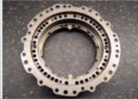
Корпус подшипника до ремонта
