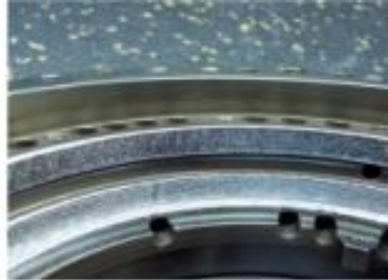
Корпус подшипника после напыления
