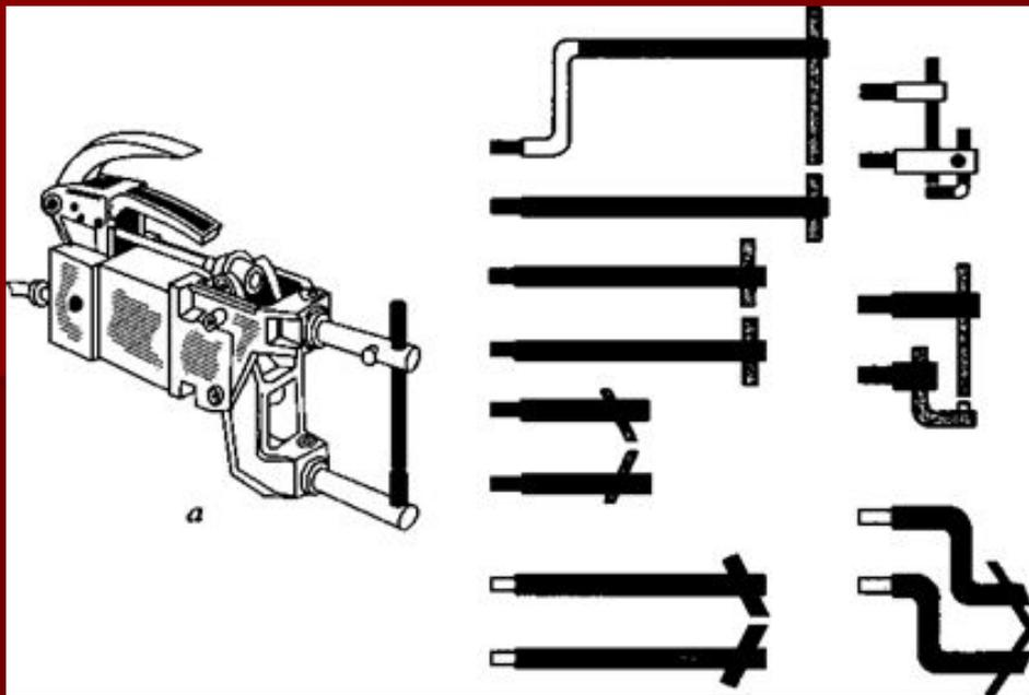
**Оборудование для электроконтактной точечной сварки: а — сварочные клещи; б — набор сварочных электродов**
