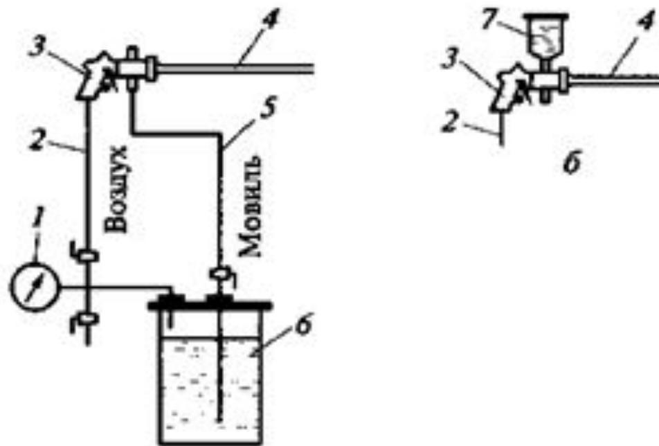
**Принципиальная схема установки для воздушного распыления защитного состава в скрытые полости:**
