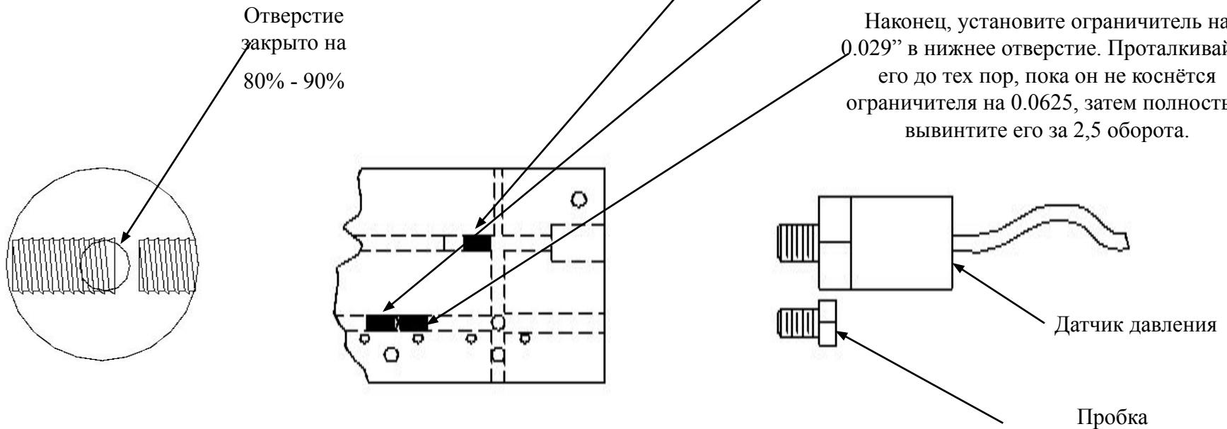
Сначала установите ограничитель на 0.018" в отверстие датчика давления. Прокручивайте его либо шесть полных оборотов, либо до тех пор, пока он не прочистит верхнее отверстие.
