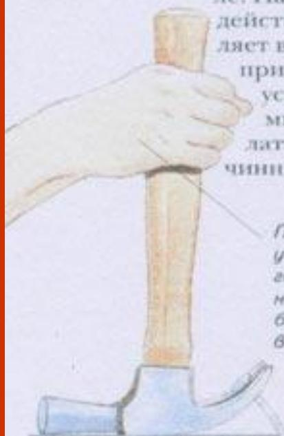
*Приложив небольшое усилие к ручке гвоздодера, мы получим на другом его конце большой выигрыш в силе*
