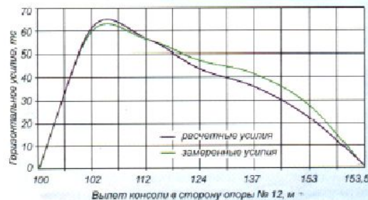
в) Горизонтальное усилие на опору 11
