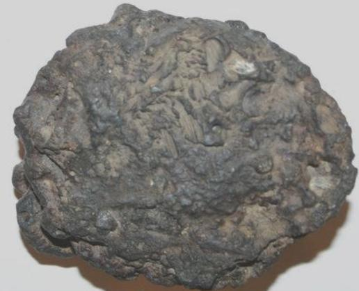
В результате содержание железа в окатышах достигает 90...95%. Далее окатыши поступают на выплавку стали в электропечах.
