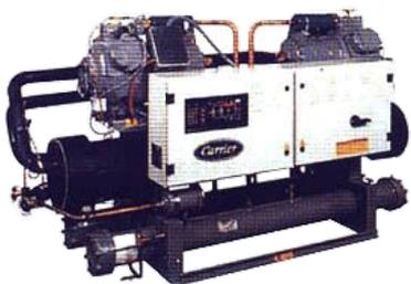
**Парокомпрессорные холодильные машины** используют энергию механического привода (чаще всего от электродвигателя) для непрерывной циркуляции рабочей среды по замкнутому контуру через аппараты, в которых последовательно изменяется ее агрегатное состояние.
