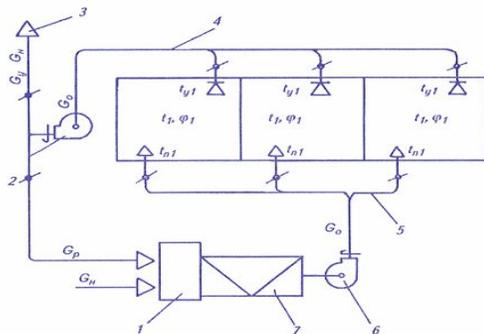
**Прямоточные СКВ** полностью работают на наружном воздухе, который обрабатывается в кондиционере, а затем подается в помещение.
