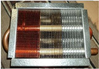
**Теплообменные аппараты.** В холодильных машинах теплообмен осуществляется теплообменными аппаратами, состоящими из теплообменников и вентиляторов. Применяются два вида теплообменников: конденсаторы и испарители.
