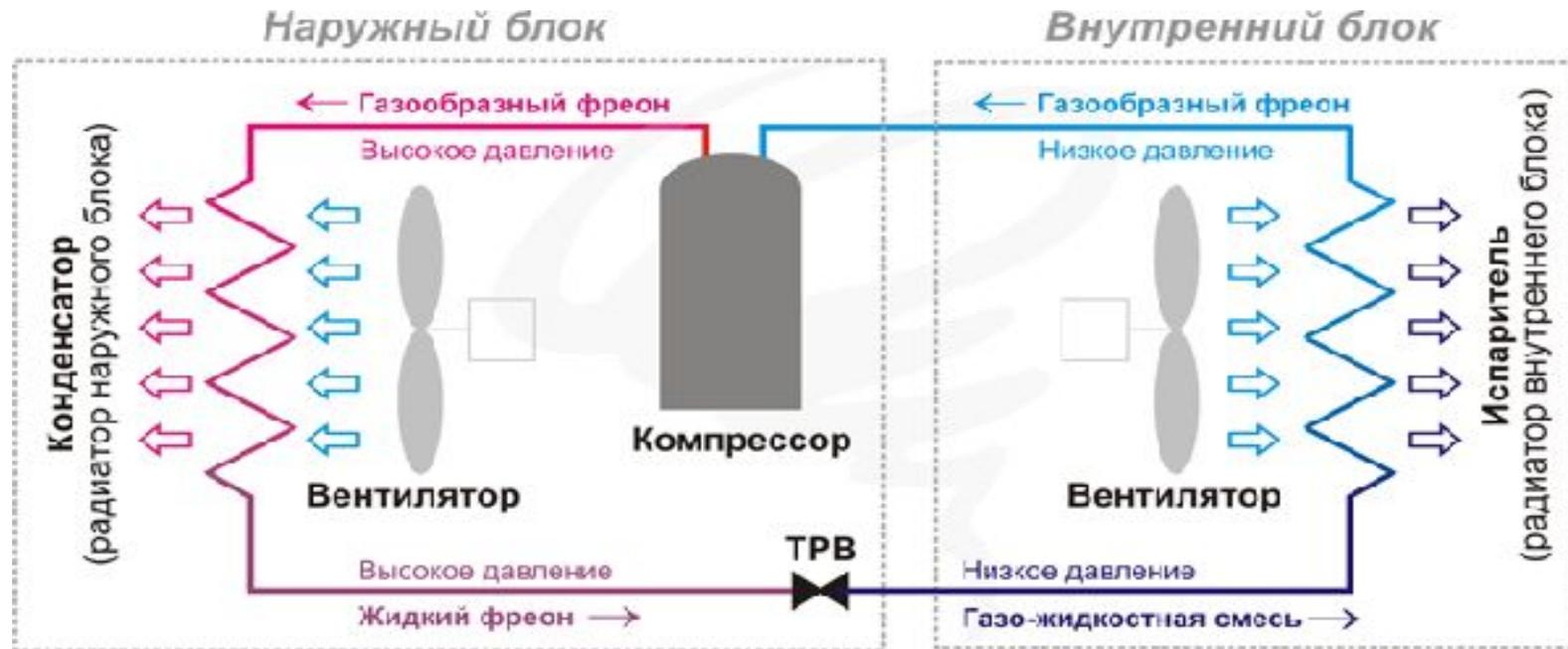
Основными узлами любого кондиционера являются: **компрессор, конденсатор, испаритель, ТРВ (терморегулирующий вентиль), вентиляторы.**
