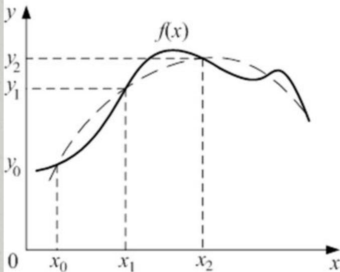
**Рис. 4.** Геометрическая интерпретация метода Симпсона
