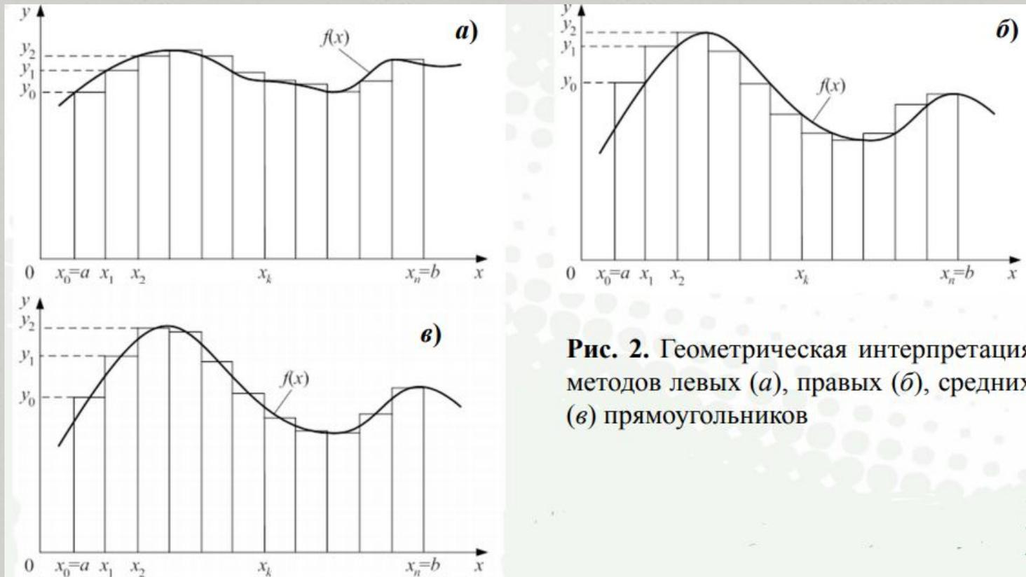
**Рис. 2.** Геометрическая интерпретация методов левых (а), правых (б), средних (в) прямоугольников
