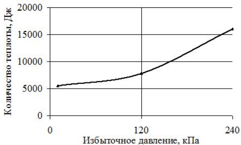
Рис. 3.14. Количество теплоты, накопленное насадкой за 180 секунды экспериментального исследования
