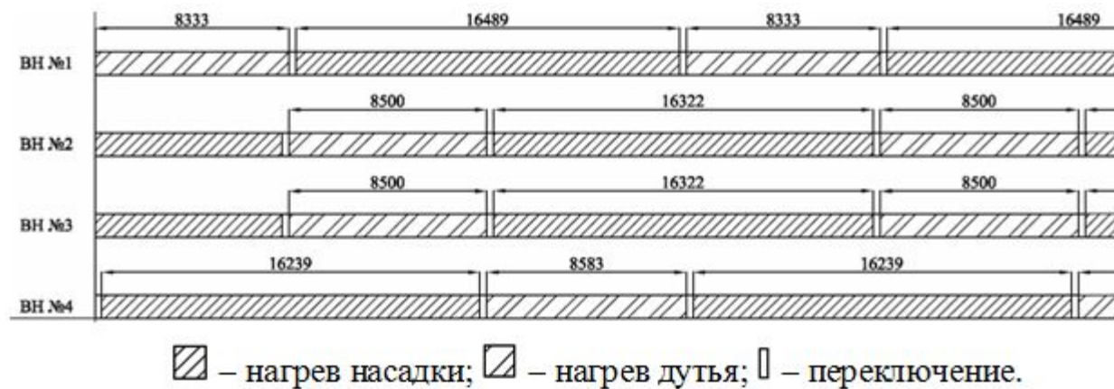
Рис. 4.14. Скорректированная режимная карта БВН
