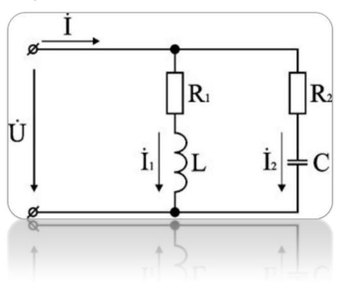
Проведем анализ работы электрической цепи в состав которой входят параллельно соединенные резистор, реальная катушка с внутренним сопротивлением и конденсатор.
