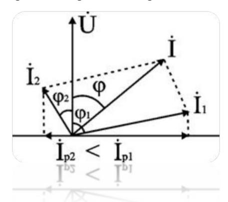
б) При  $b_1 < b_2$  токи  $I_{1p} < I_{2p}$ ,  $\phi < 0$ . Цепь имеет активноемкостный характер.
