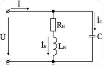
Расчет емкости дополнительного конденсатора для обеспечения заданного  $\cos \varphi$  проводится следующим образом. Пусть известны параметры нагрузки  $P_{_{\rm H}},$  U и  $I_{_{\rm H}}$  . Можно определить  $\cos \varphi_{_{\rm H}}$
