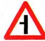
2.3.3 Примыкание второстепенной дороги
