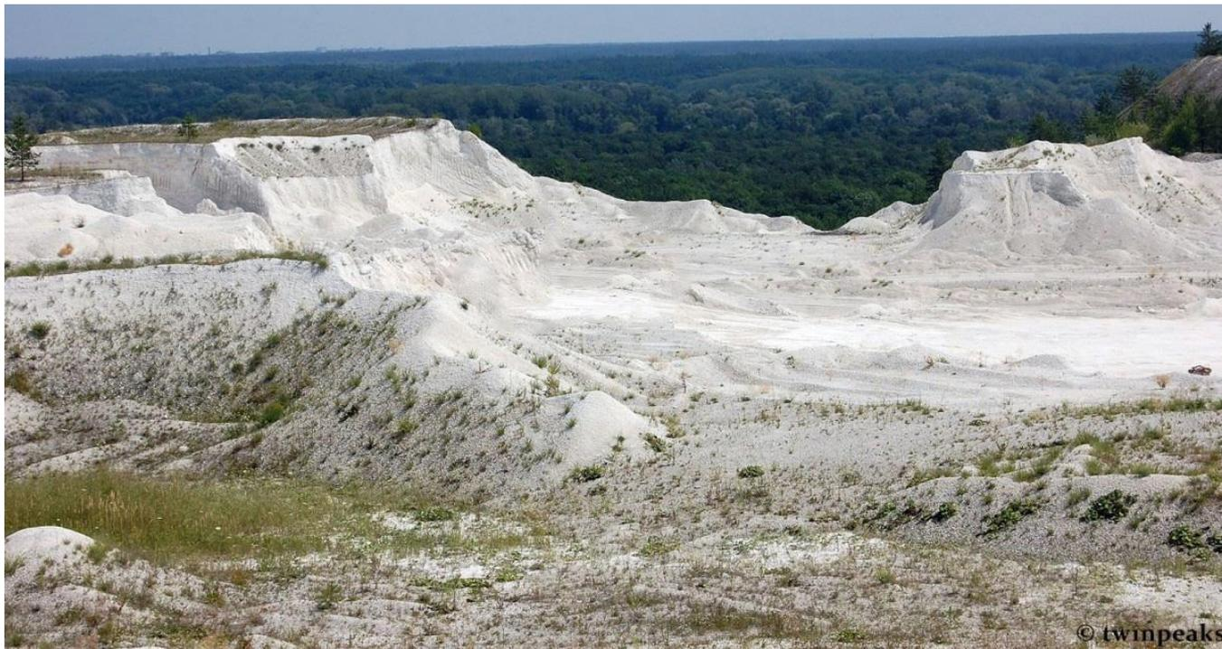
**Диатомит** (или кизельгур) – горная порода, образованная скоплениями панцирей диатомовых водорослей, обитавших в древних морях. Рыхлый, очень пористый, светло-серого или желтоватого цвета, с низким удельным весом. Когда диатомит измельчается в порошок, его обычно называют «диатомовой землей». Кроме кремния входят и другие полезные вещества – фосфор, кальций, магний и многие другие.
