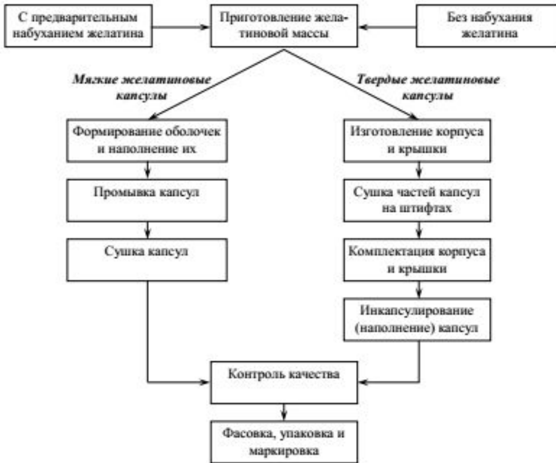
Рис. 6.1. Схема технологического процесса получения различных видов желатиновых капсул
