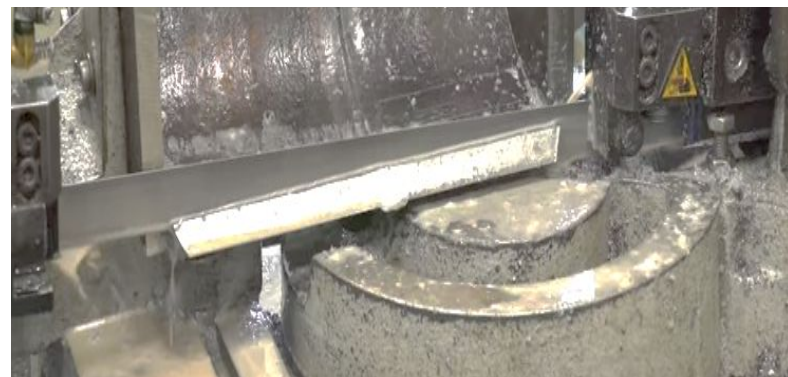
Распил образцов на заготовки
