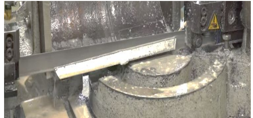
Распил образцов на заготовки
