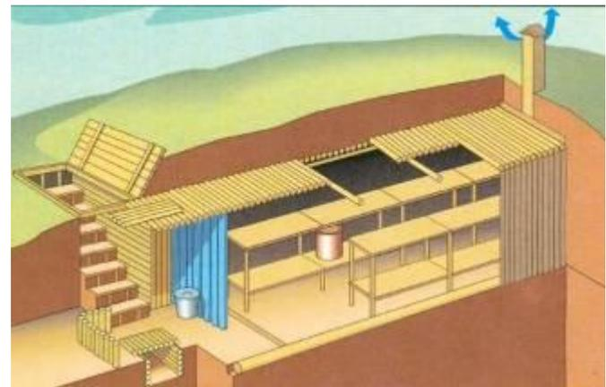
Противорадиационное укрытие, кроме защиты от радиоактивного заражения, защищает также от светового излучения, уменьшает воздействие ударной волны, значительно снижает воздействие проникающей радиации, а также защищает от полива жидкими отравляющими веществами и частично от химических и биологических аэрозолей.
