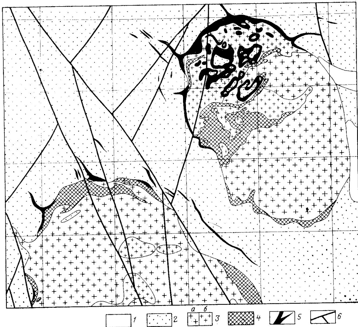
Рис. 42. Схема геологического строения альбититовых массивов, Казахстан. По В. Белову и др. 1 — четвертичные суглинки; 2 — алевролиты и туфопесчаники; 3 — альбититы ранние (а) и поздние (б); 4 — пегматоидные граниты; 5 — рибекитовые и эгириновые метасоматиты; 6 — тектонические нарушения
