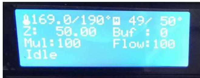
Верхняя строчка показывает некоторые цифры примерно вот такие 22.3/0 и 22/0. Это индикация температур принтера. Первая 22.3/0 означает текущую температуру экструдера, как правило она отображает температуру окружающей среды. Вторая 22/0 означает текущую температуру стола.
