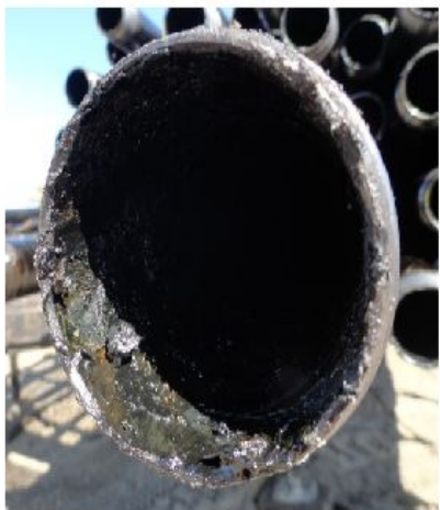
НКТ без защитного покрытия НКТ с покрытием MajorPack Сравнение состояния НКТ без защитного покрытия и с покрытием MajorPack
