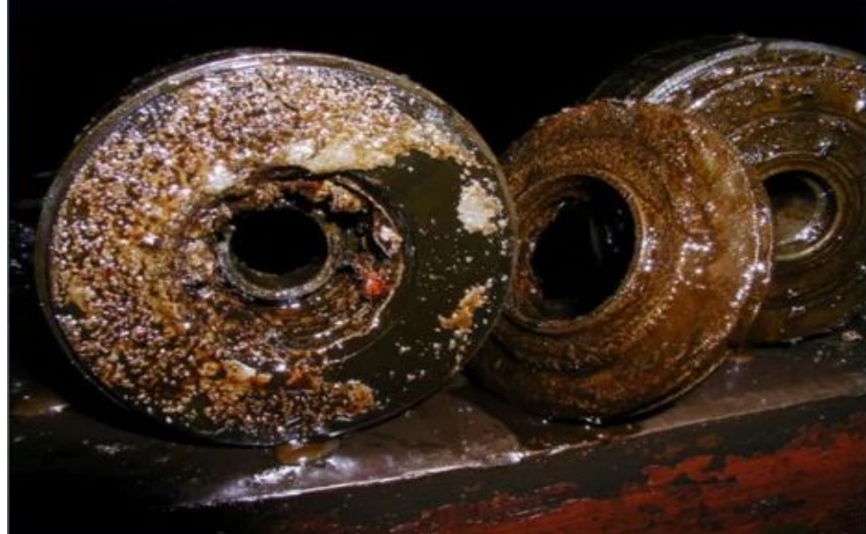
Отложение солей на рабочих колесах центробежного насоса
