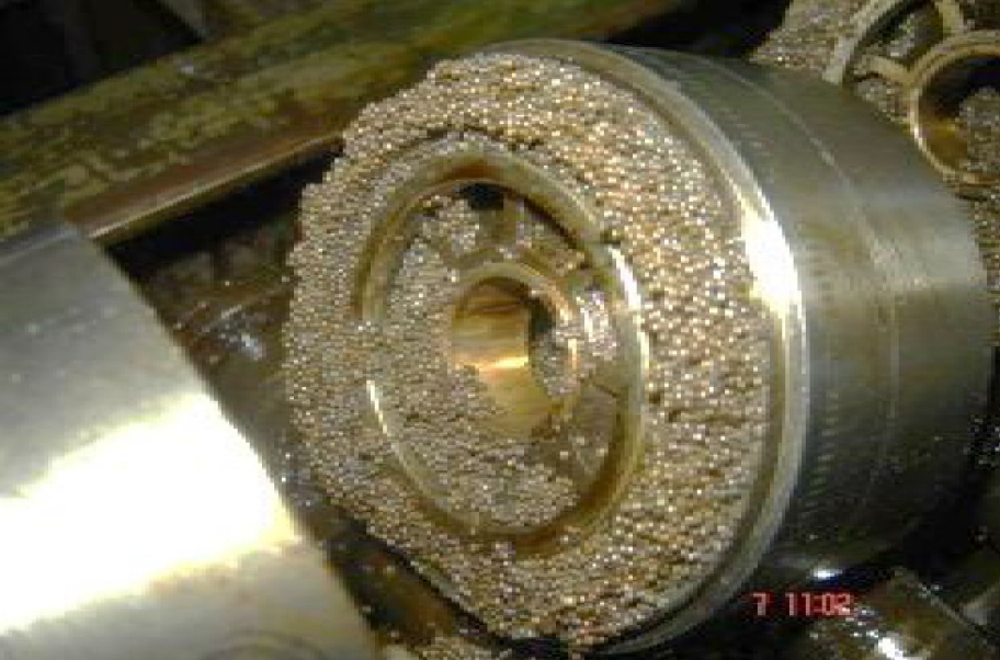
Засорение рабочих коле УЭЦН проппантом
