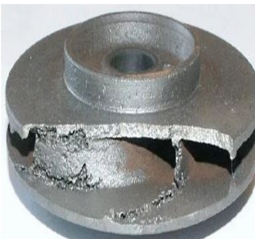
Рабочие органы ЦЭЦН под влиянием высокого газового фактора
