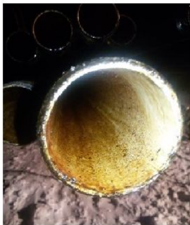
НКТ без защитного покрытия НКТ с покрытием MajorPack Сравнение состояния НКТ без защитного покрытия и с покрытием MajorPack
