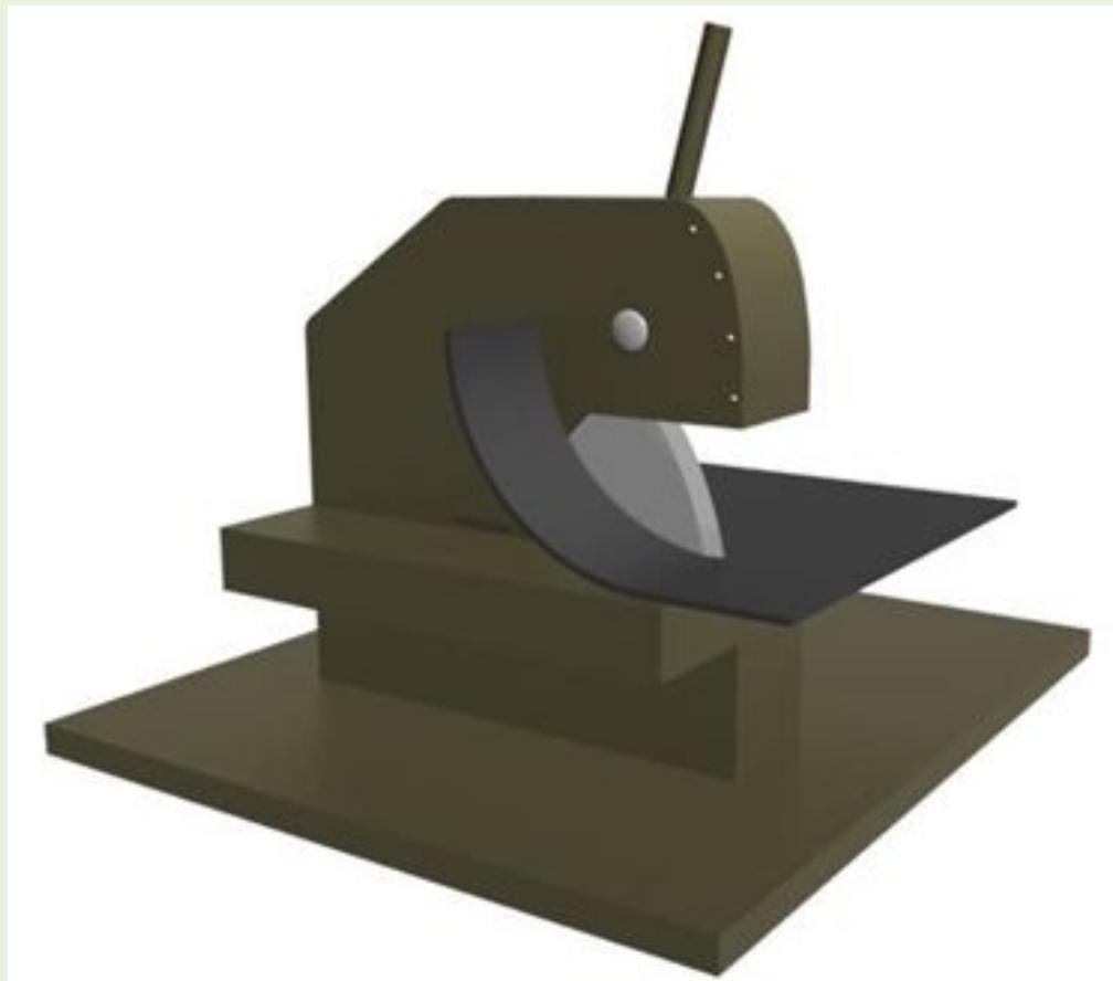
С помощью рычажных ножниц можно разрезать листовой металл толщиной до 4 мм и мягкий металл толщиной до 6 мм.
