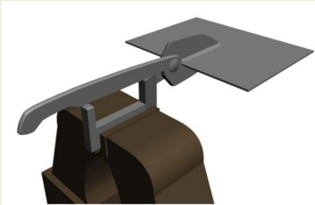
Силовые ножницы применяют в том случае, когда необходимо разрезать металл толщиной 1,5 - 2,5 мм.
