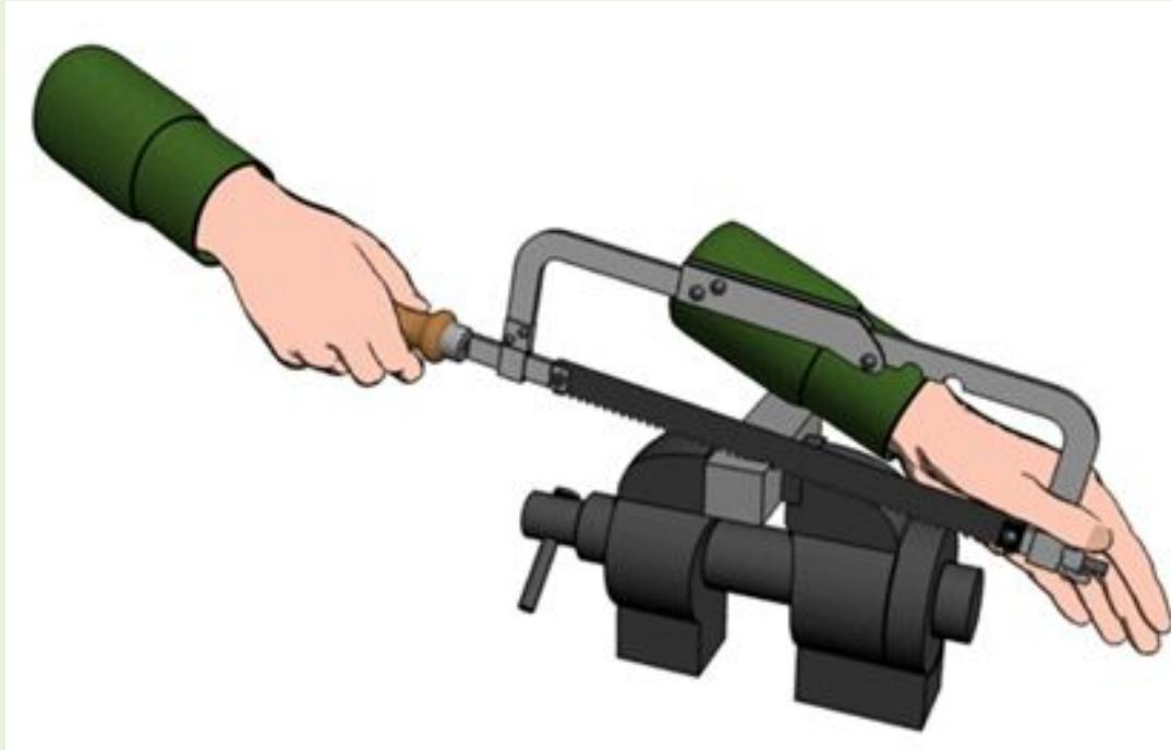
При разрезании металла квадратного сечения или полосы в начале операции ножовку наклоняют вперед, а затем режут при горизонтальном положении инструмента. Полосу целесообразно резать по узкой стороне.
