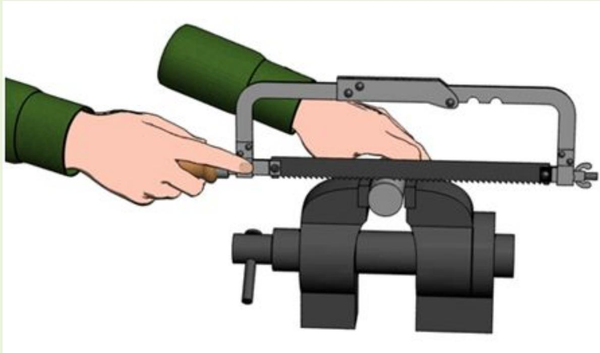
Круглые заготовки при разрезке предварительно размечают, зажимают в тиски и для лучшего направления ножовочного полотна по разметочной риске делают напильником неглубокую канавку. На неразмеченной заготовке у места реза ставят большой палец левой руки, к его ногтю плотно приставляют ножовочное полотно, а правой рукой перемещают ножовку.
