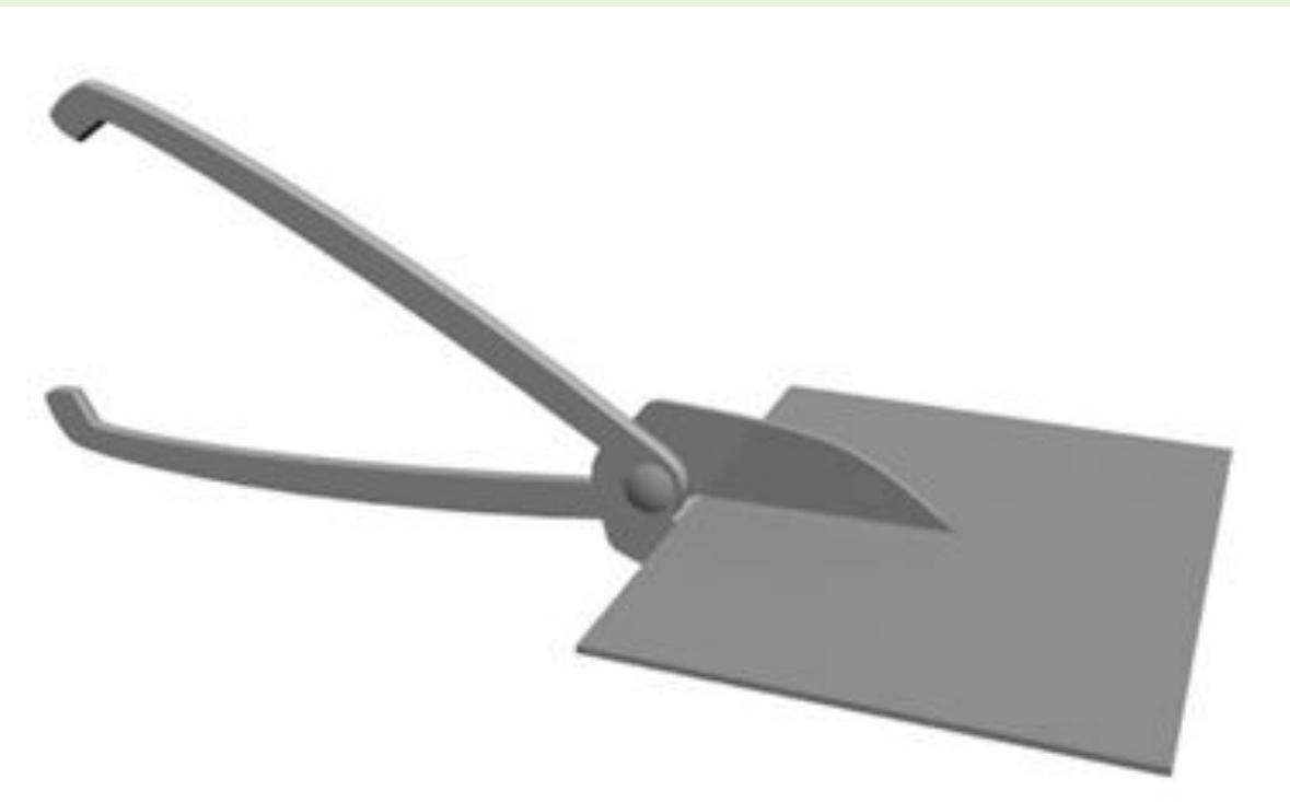
Ручные ножницы используют при разрезании металла толщиной 0,5 - 1,5 мм. Лезвия ножниц при этом следует разводить примерно на три четверти их длины, а лист металла нужно располагать перпендикулярно к плоскости режущих кромок ножниц. При сжатии ручек ножниц лезвия до конца сводить не следует, так как это приводит к разрыву металла в конце разреза.
