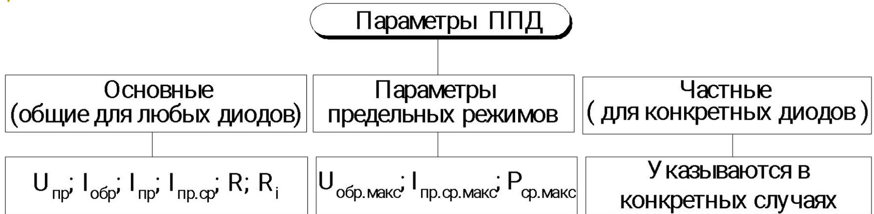
Рис.7. Классификация параметров полупроводниковых диодов
