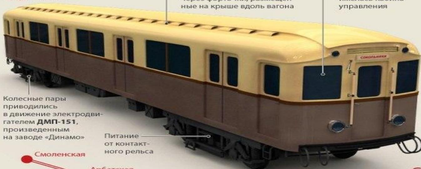
Колесные пары приводились в движение электродвигателем ДМП-151, произведенным на заводе «Динамо»
