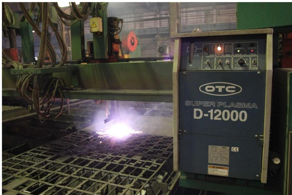
**плазменная резка листового металла**
