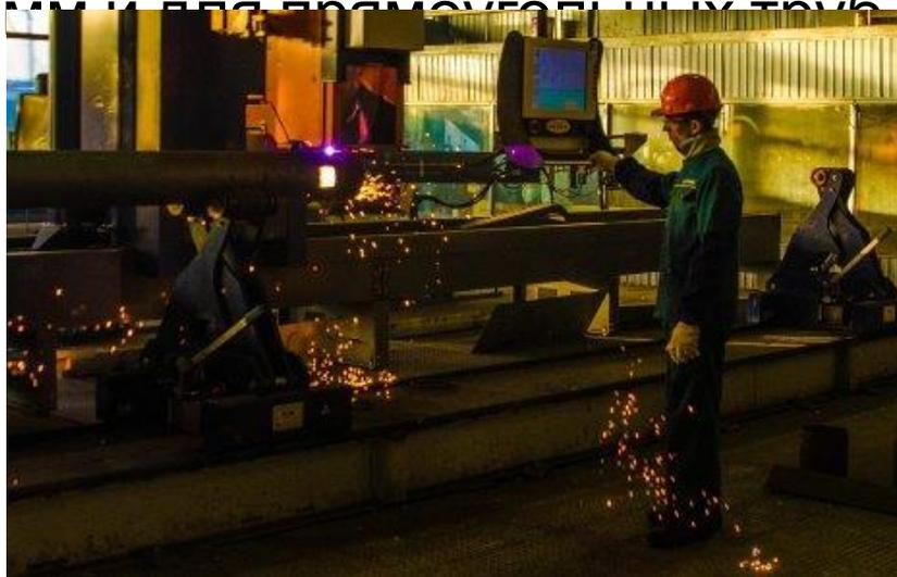
**термическая резка труб**
