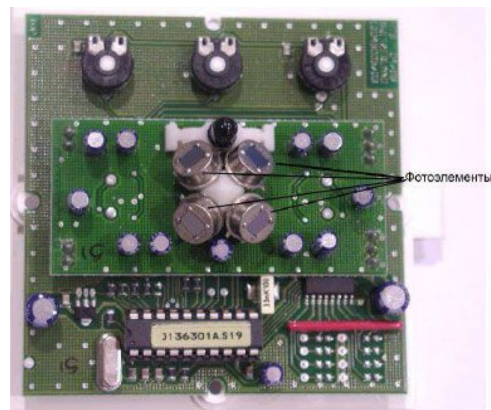
Устройство ИК датчика
