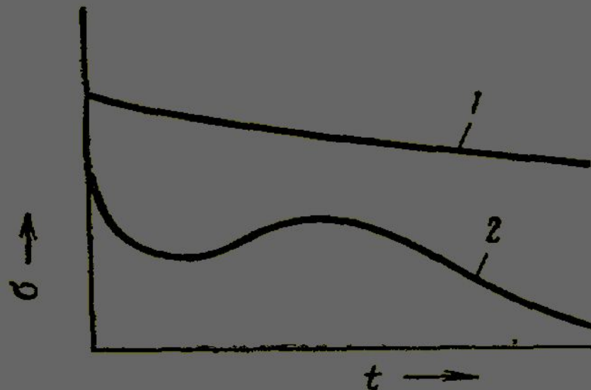
Рис. V, 2. Зависимость поверхностного натяжения \sigma от температуры: 1 — индивидуальная жидкость; 2 — раствор поверхностно-активного вещества.
