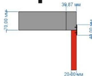
металлическая пластина для монтажа профиля к существующему каркасу
