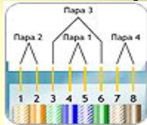
**Схемы обжима витой пары** для разъемов RJ-45 различаются в зависимости от назначения соединительной линии, технологии и стандарта передачи данных. Может потребоваться как прямая, так и обратная (или перекрестная, т.н. кросс-линковая) обжимка патчкорда.
