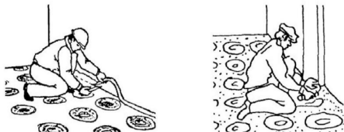
Рис. 4.2 - Прирезка полотен линолеума по контуру помещения
