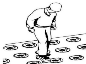
Рис. 4.6 - Прикатывание линолеума ножным катком
