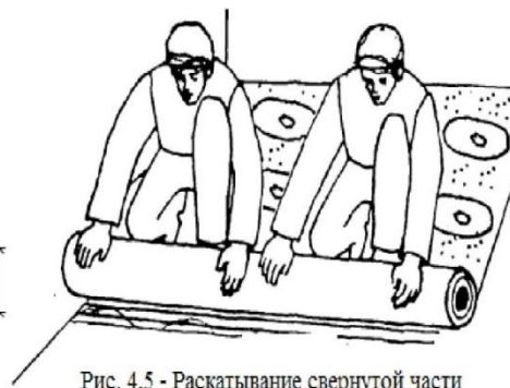
Рис. 4.5 - Раскатывание свернутой части полотна линолеума
