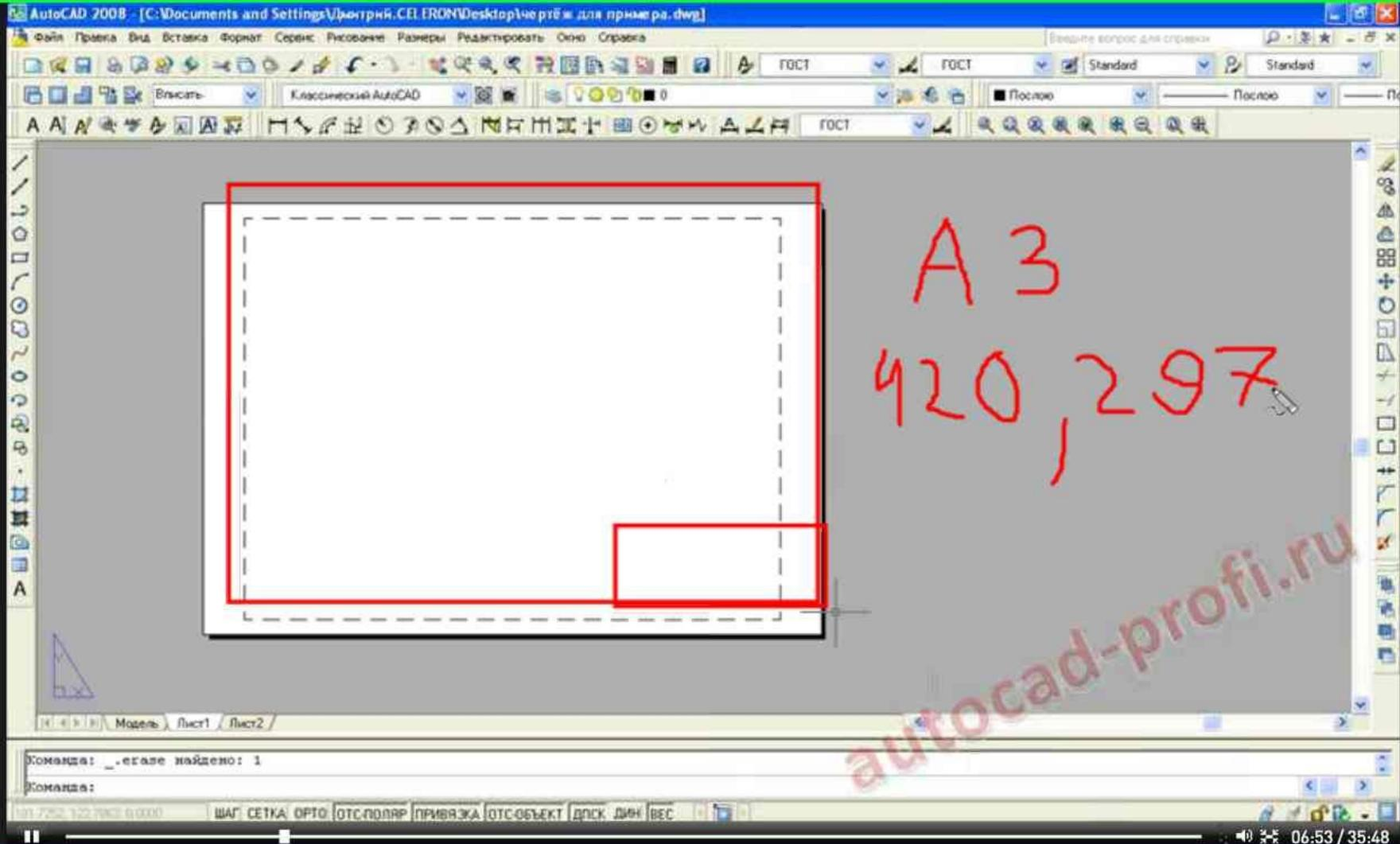
Для примера, распечатаем чертеж на листе формата А3 с размерами 420 мм x 297 мм по ширине и высоте соответственно.
