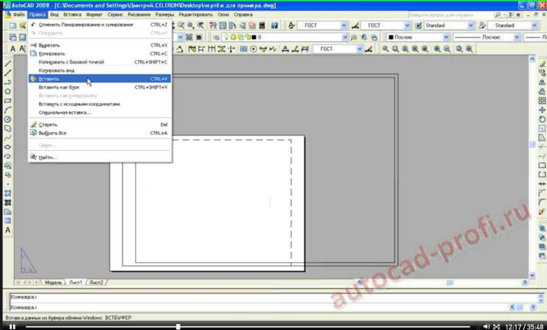
Возвращаемся в чертеж с листом, нажимаем на кнопку «Правка» и нажимаем на пункт «Вставить»
