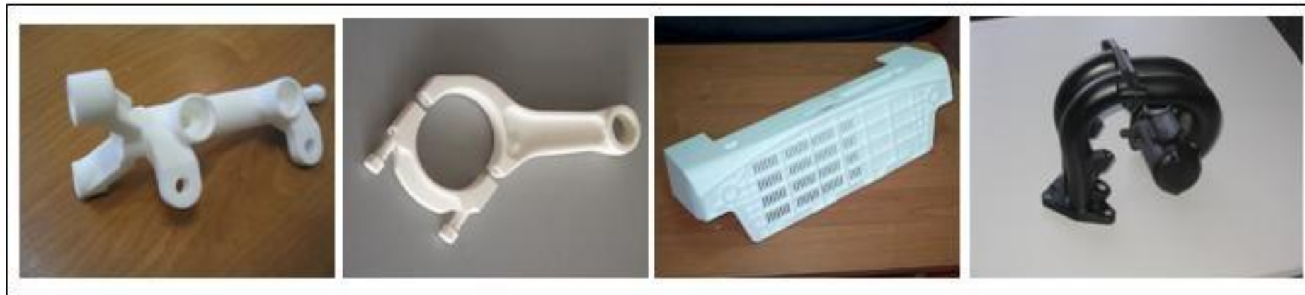
Прототипы построенные по SLS-технологии.
