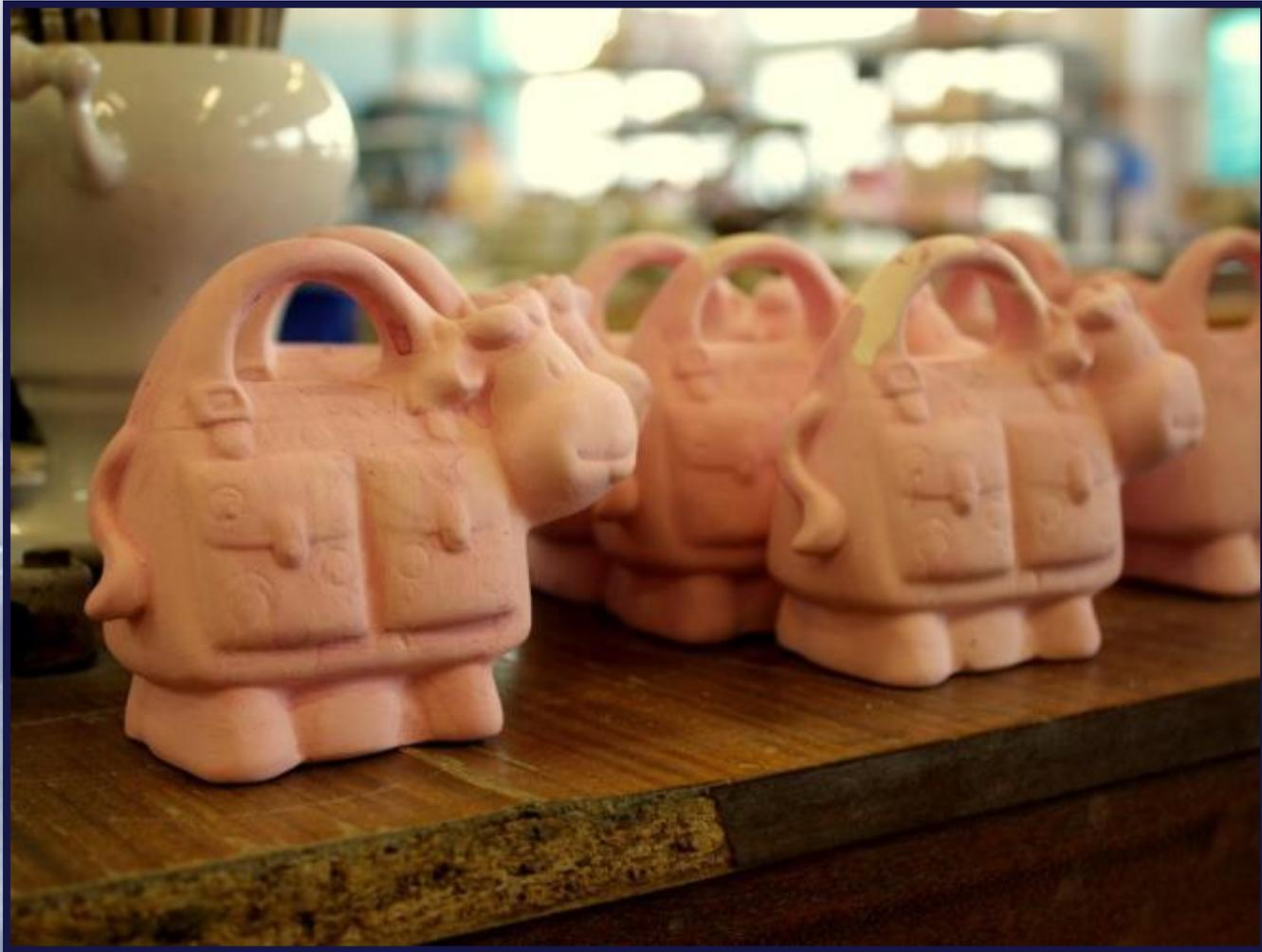
После обжига фигурку окунают в подкрашенную воду. Так очень легко найти дефекты — различного рода трещины. Состав красителя такой, что после повторного обжига он выгорает без следа. После второго обжига изделие начинают расписывать.
