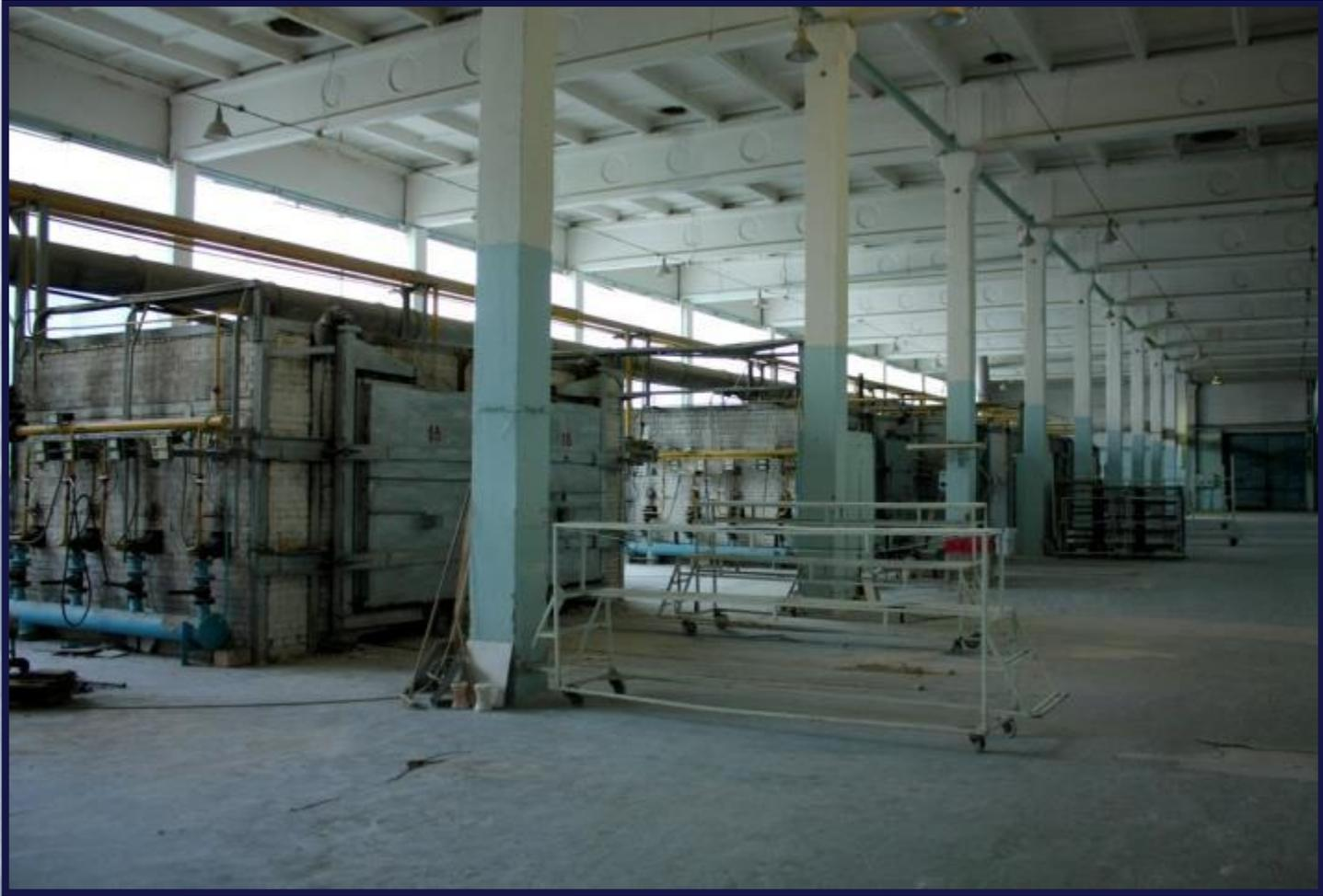
После этого формы на палетах загоняют в печи. Обслуживает печь обжигальщик. Это очень важная профессия. Если обжигальщик поставит одну деталь с краю печи, а другую в центре, то в процессе обжига они ужмутся по-разному и будет брак.
