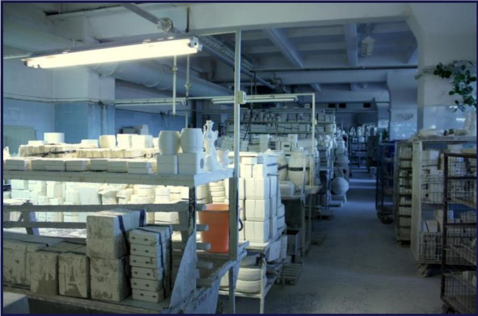
Это формовочный цех. Здесь смесь из которой потом получится фарфор заливают в формы и дают затвердеть.
