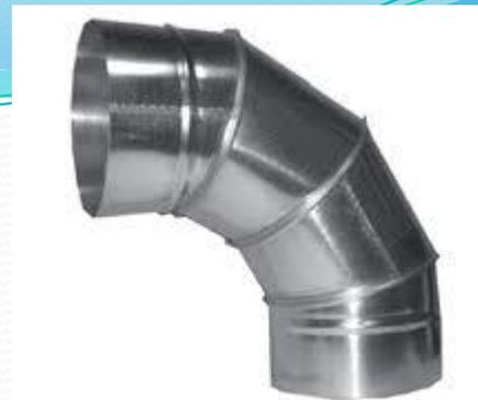
Воздуховоды изготавливаются из оцинкованной стали в соответствии с требованиями СНиП 2.04.05-91, ТУ 4863-001-92743772-12. Соединение всех воздуховодов – ниппельное, с использованием силиконового герметика и с фиксацией саморезами или заклепками. Стандартная длина воздуховодов – 2000, 3000, 4000 и 6000мм. Возможно изготовление большей длины по желанию Заказчика. Максимальная длина воздуховода – 12000мм.
