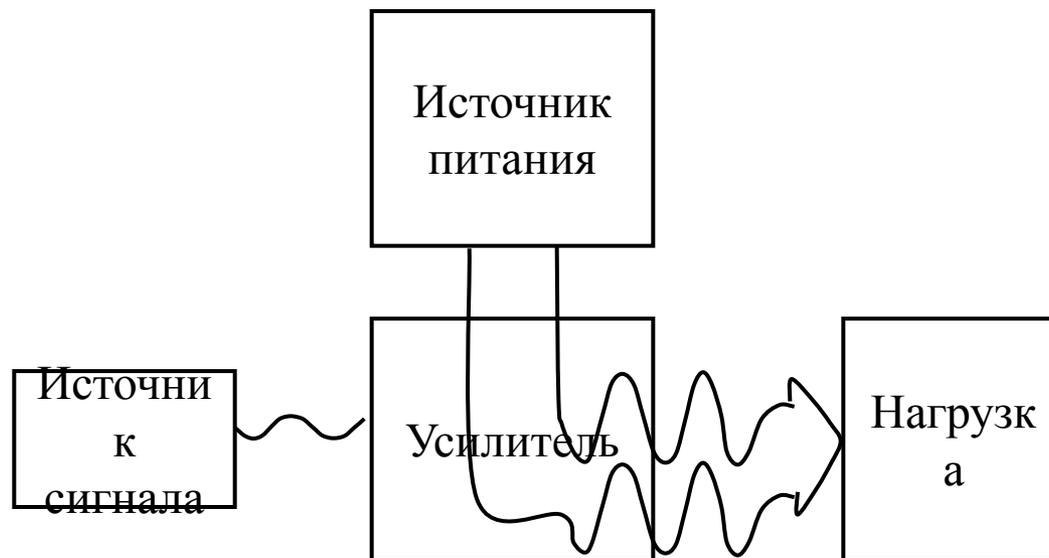
Рисунок отображающий принцип преобразования мощности источника питания
