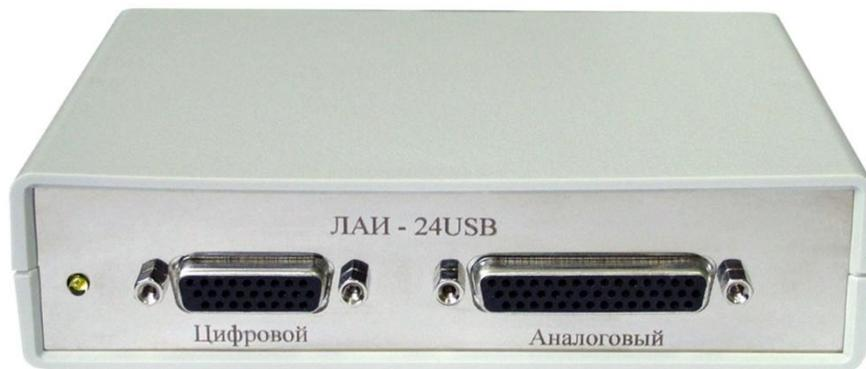
4 синхронных дифференциальных АЦП 24 разряда, до 800 Гц каждый
