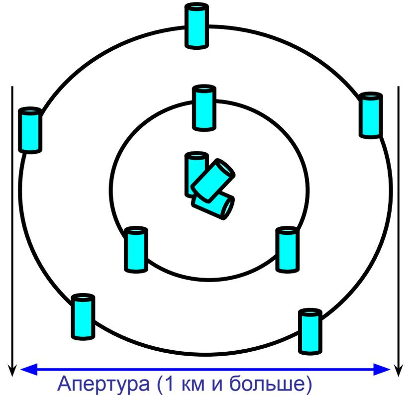
Способна обнаруживать более слабые сейсмические события, чем трехкомпонентная станция. По задержкам времен приходов волны на разные датчики можно рассчитать азимут прихода волны (в целом точнее, чем по трехкомпонентной станции) и ее кажущуюся скорость (относительно поверхности).
