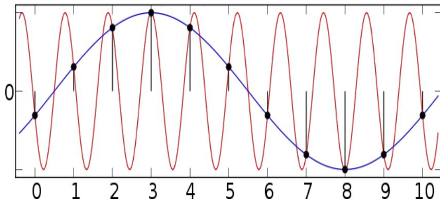
**Алиасинг.** Сигнал с частотой  $f > f_N$  (красный график) при оцифровке неотличим от низкочастотного с частотой  $f_d - f$  (синий).
