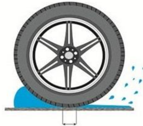
Площадь контакта шин при заезде в воду
