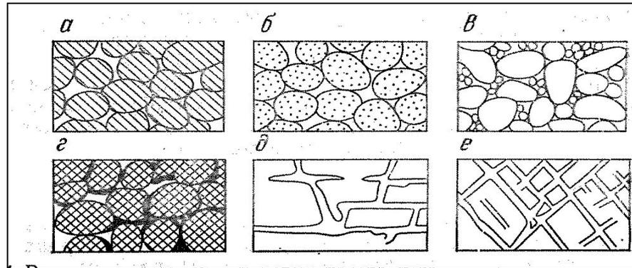
Рис.1. Различные структуры поровых пространств. Обломочные породы: *a* – высокопористые с хорошо окатанными зернами; *б* – очень высокопористые с хорошо окатанными отсортированными и пористыми зернами; *в* – низкопористые с плохо окатанными и отсортированными зернами; *г* – пониженной пористости с хорошо окатанными, но сцементированными зернами; *д* – с порами растворения; *е* – с трещинной пористостью.
