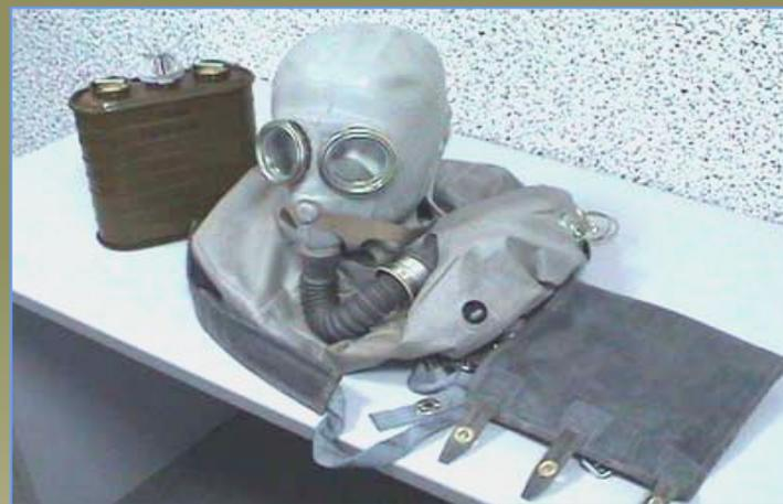
**Лицевая часть** изолирующего противогаза служит для изоляции органов дыхания и зрения от окружающей среды, направления выдыхаемой газовой смеси в регенеративный патрон, подведения очищенной от углекислого газа и паров воды и обогащенной кислородом газовой смеси к органам дыхания.
