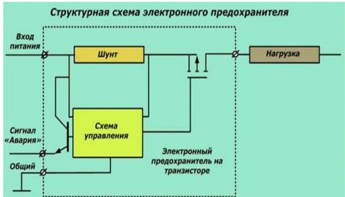
Схема управления такого предохранителя снимает измеряемый сигнал о величине тока с резистивного шунта. Он модифицируется и подается на вход изолированного полупроводникового затвора полевого транзистора.
