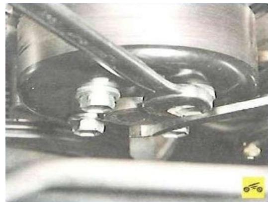
18. Снять переднюю крышку двигателя,
