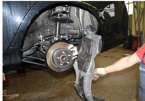
6. Снять брызговик двигателя.
