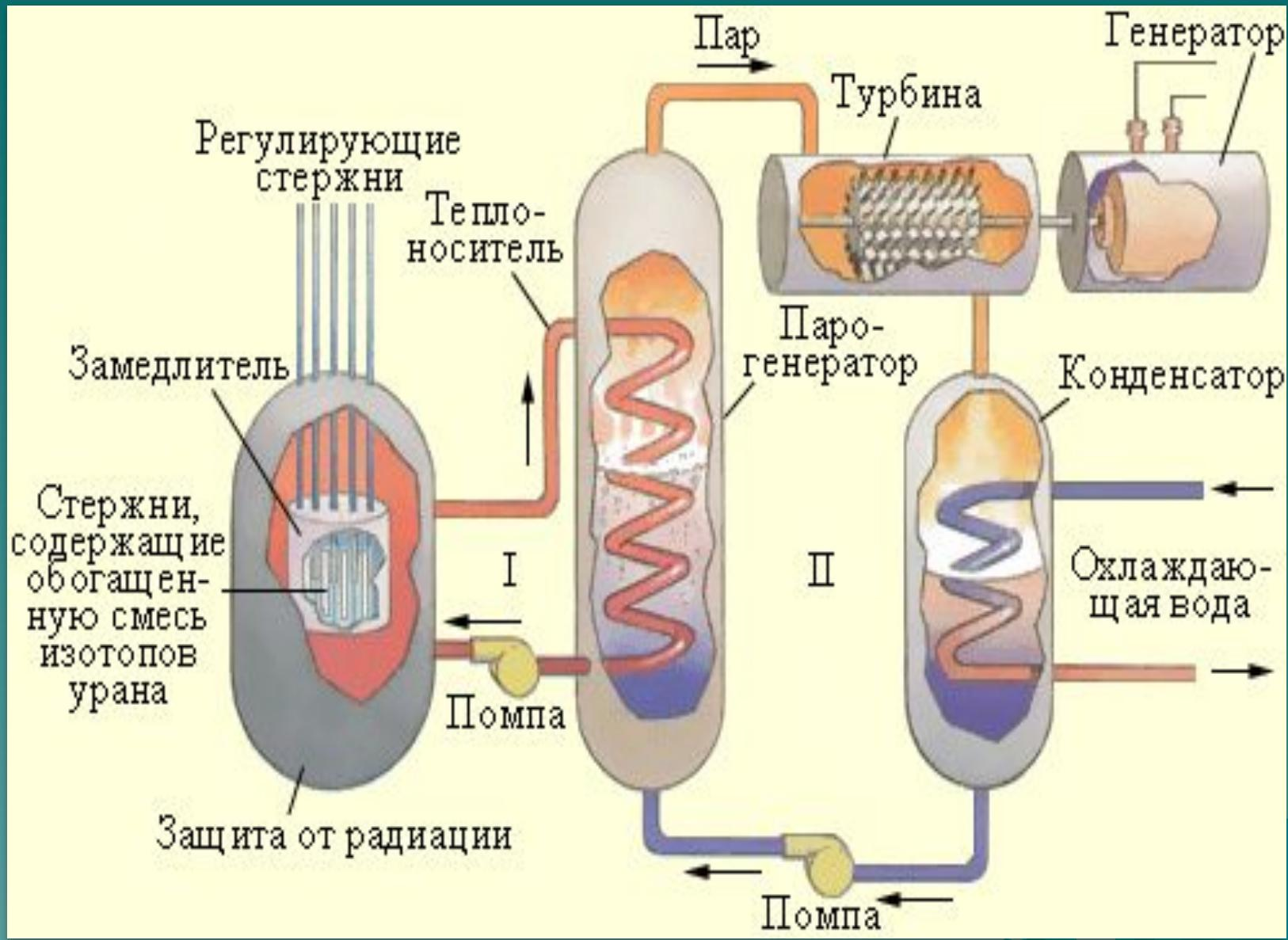
Управление реактором осуществляется при помощи стержней, содержащих кадмий или бор.
