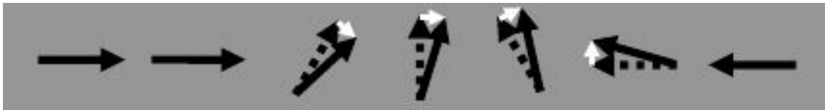
Рис. Иллюстрация индуцированного током движения доменной стенки, обусловленного механизмом переноса спина. Неравновесная поперечная компонента поляризации носителей (белые стрелки) передается магнитным моментам внутри доменной стенки (черные стрелки); это приводит к движению последней.
