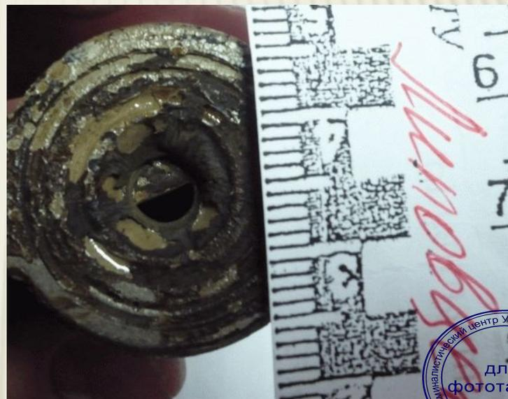
Фото 2. Внешний вид поврежденной дужки замка
