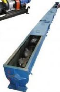
Шнек для транспортування відходів буріння
