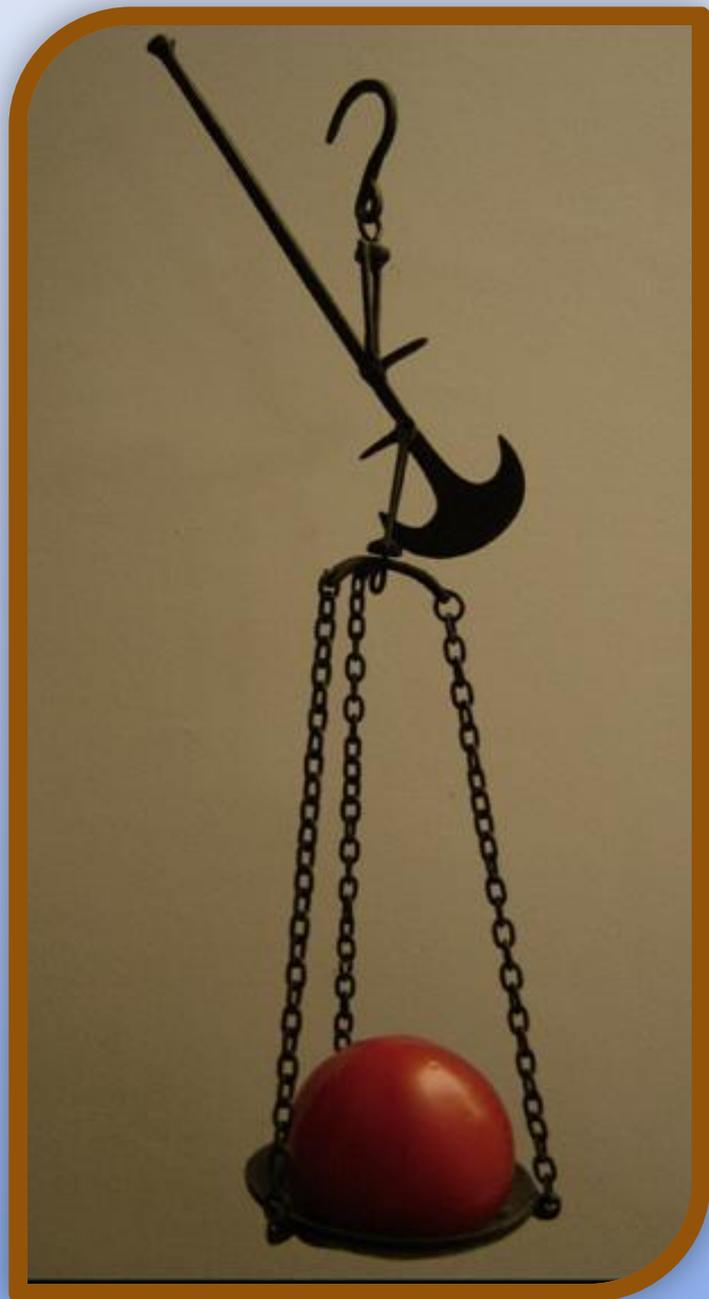
Уже в начале нашего времени древние римляне несколько модернизировали весы. Сквозь отверстие в горизонтальной балке стали продевать тонкий стержень или булавку вместо веревки. Такие весы стали называть **безменом**.
