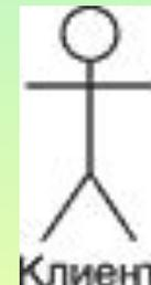
Графическое обозначение актера
