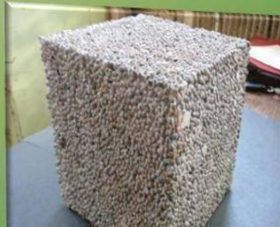
Переработка стекла в пеностекло
