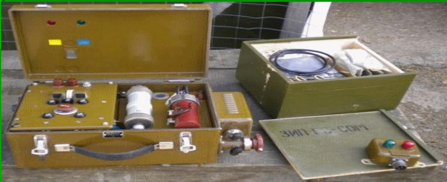
Комплекс наземной дистанционной химической разведки КДХР-1Н «Даль». Площадь дистанционного контроля приземного слоя атмосферы за время кругового обзора – до **70 км<sup>2</sup>**. Дальность определения фосфорорганических отравляющих веществ в момент вскрытия боеприпаса и начальный период формирования облака – **7 км**.
