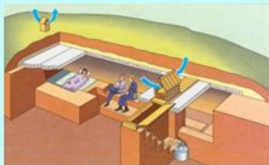
Быстровозводимое ПРУ из железобетонных плит
