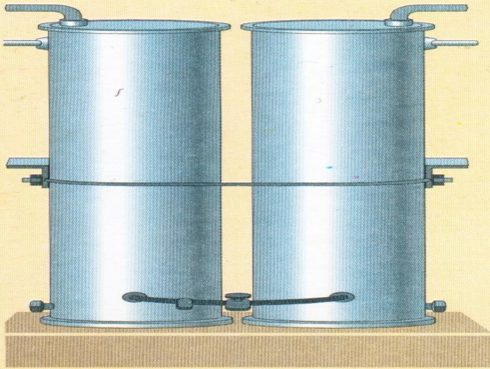
Вертикальный бак аварийного запаса воды
