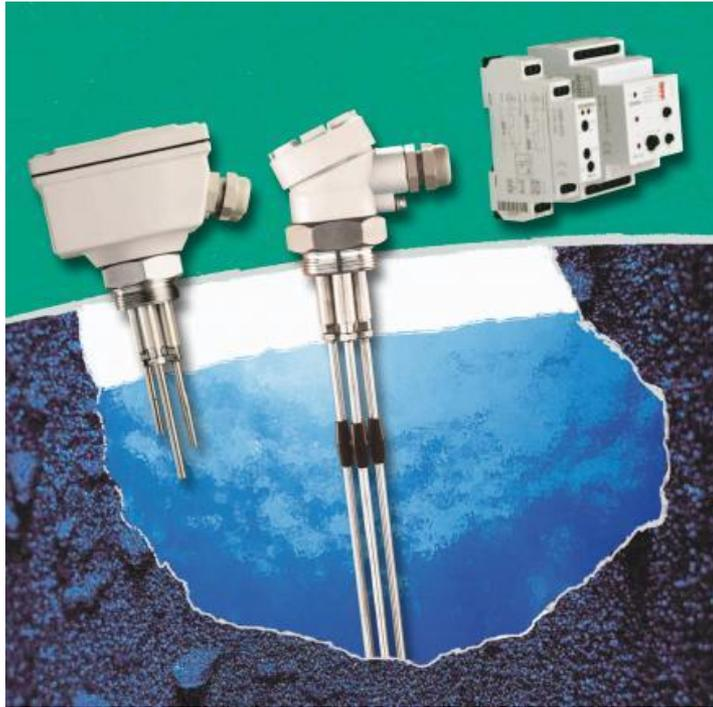
Наличие продукта вызывает изменение сопротивления между двумя проводящими зондами, один из которых может быть проводящая стенка емкости
