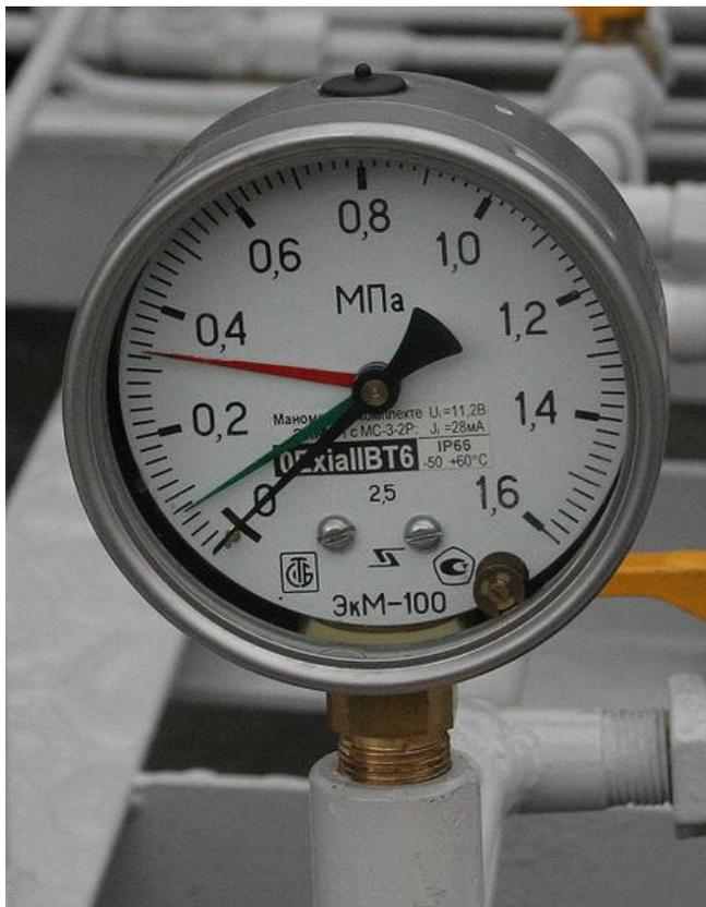
Традиционная конструкция механического манометра
