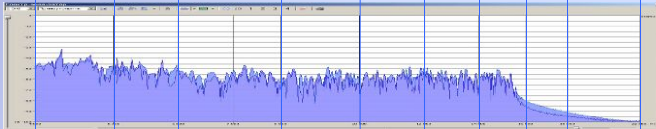
Спектрограмма сжатого звука (формат WMA, битрейт 128 кбит/с)
